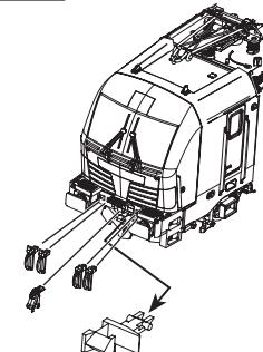
**Beleuchtung:** Das Fahrzeug ist mit wartungsfreier LED Stirnbeleuchtung ausgestattet!
