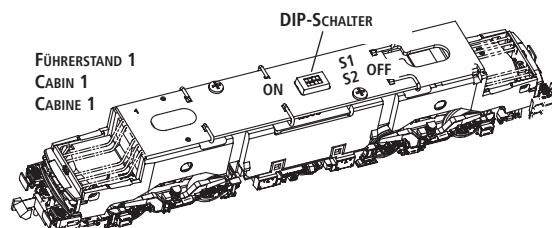
**Hinweis:** Die Stirnbeleuchtung der Lok kann mit Hilfe der DIP-Schalter S1 (für FS2) oder S2 (für FS1) auf der Platine für jede Lokseite abgeschaltet werden.
